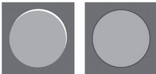
Figura 14.7. Utilización del reventado. A la izquierda, una imagen fuera de registro deja ver áreas blancas entre el objeto y el fondo. A la derecha, el objeto se ha reventado sobre el fondo para cubrir cualquier área blanca entre ambos.
